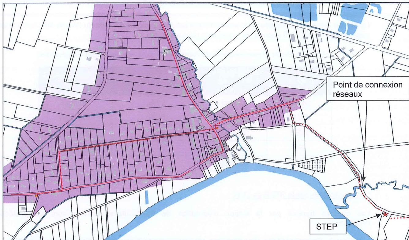
Figure 4 – Connexion des réseaux d'assainissement entre Porchères et Saint-Antoine-sur-l'Isle
